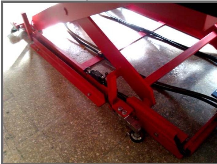
Sistema de pesaje con células de carga y módulo visualizador
